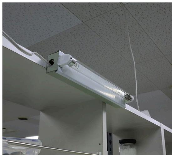
図23. UVランプによる恒温培養装置内及び設置環境の滅菌
