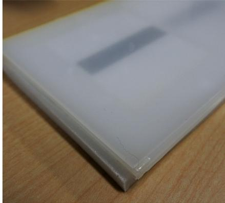
図 4 予備実験に用いた半透明の亚克力板. 亚克力板の下に黒紙を設置した.
