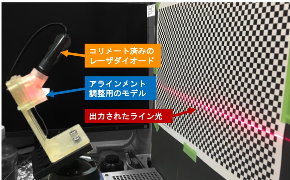
図 25 MEMS ミラーとパウエルレンズを用いて試作した光源システム. ライン光が出力されていることがわかる.
