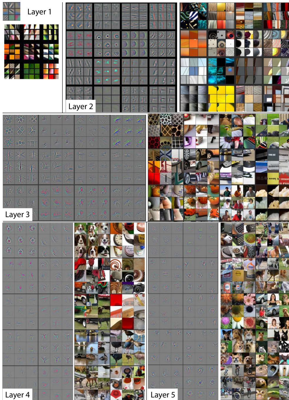
図 1.2 ニューラルネットワークの中間層における特徴量の可視化（第一層はエッジなどの局所的な特徴量を得ているのに対し，第5層では，物体や動物の全体像の特徴量を得ている） [1]
