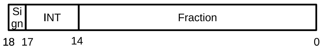
図 17: phase, phase', \Delta phase , \sin(\text{phase}') , \cos(\text{phase}') のビットフォーマット
