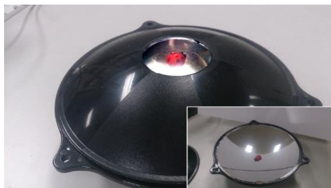
図 7 2枚の向かい合わせ放物面鏡
