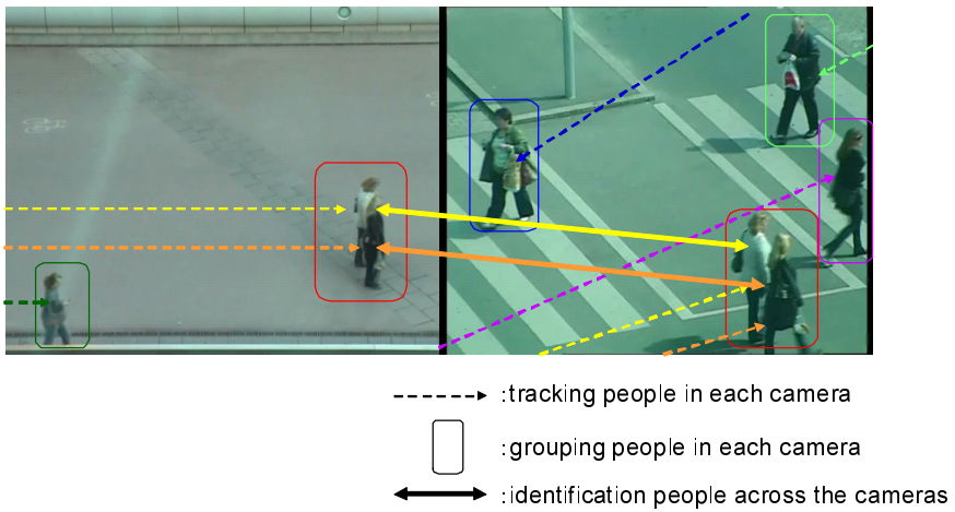
図 3 監視カメラの映像例. 広域人追跡の実現には, 各カメラの視野内で撮影された人の追跡 (各破線) と, 各カメラで撮影された人の中で同一人物判定を行うカメラ間人同定 (各実線) が必要. 各枠はそれぞれグループを示しており, 赤枠内の 2 人は同一グループ.
