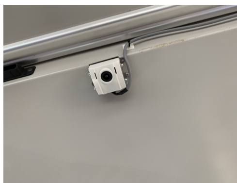
図 18: 技研トラステム社製乗降客カウントセンサ
