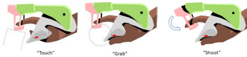
図 2.5: 力覚センサとサーボモータを用いた指先への触覚提示デバイスによる提示パターン [17].
