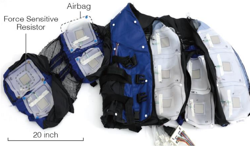
図 2.3: 空気圧バルーンを用いた上部各部への触覚提示デバイス [16].
