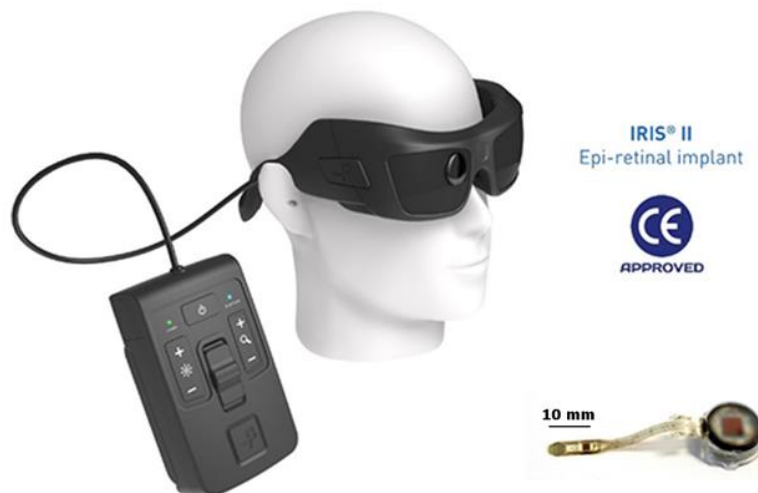
図 2-10 網膜上刺激方式の代表例：IRIS II (Pixium Vision 社, フランス) [22]. (左) 体外装置：ゴーグルおよびビデオ処理ユニット. (右下) 体内装置：150 極を搭載する刺激電極アレイ.
