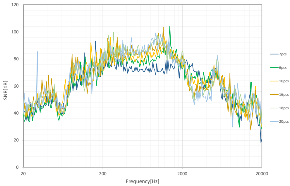
図 25: 質量ごとのセンサ SN 比の周波数特性
