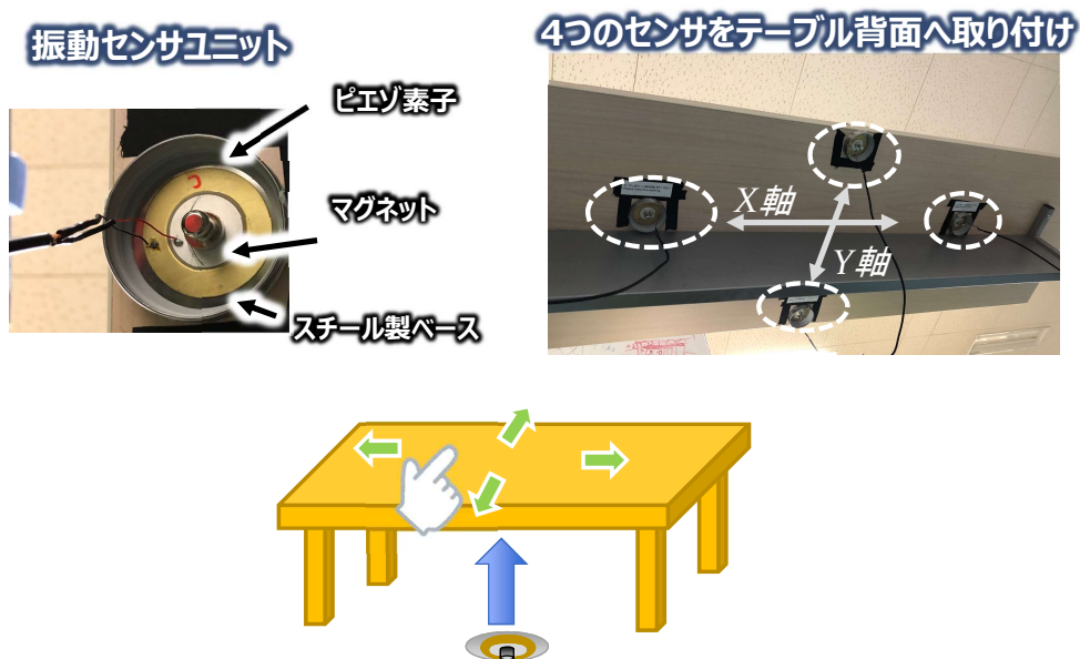
図 3: 実験で使した振動センサユニットの構造とセンサの取り付け状態の例
