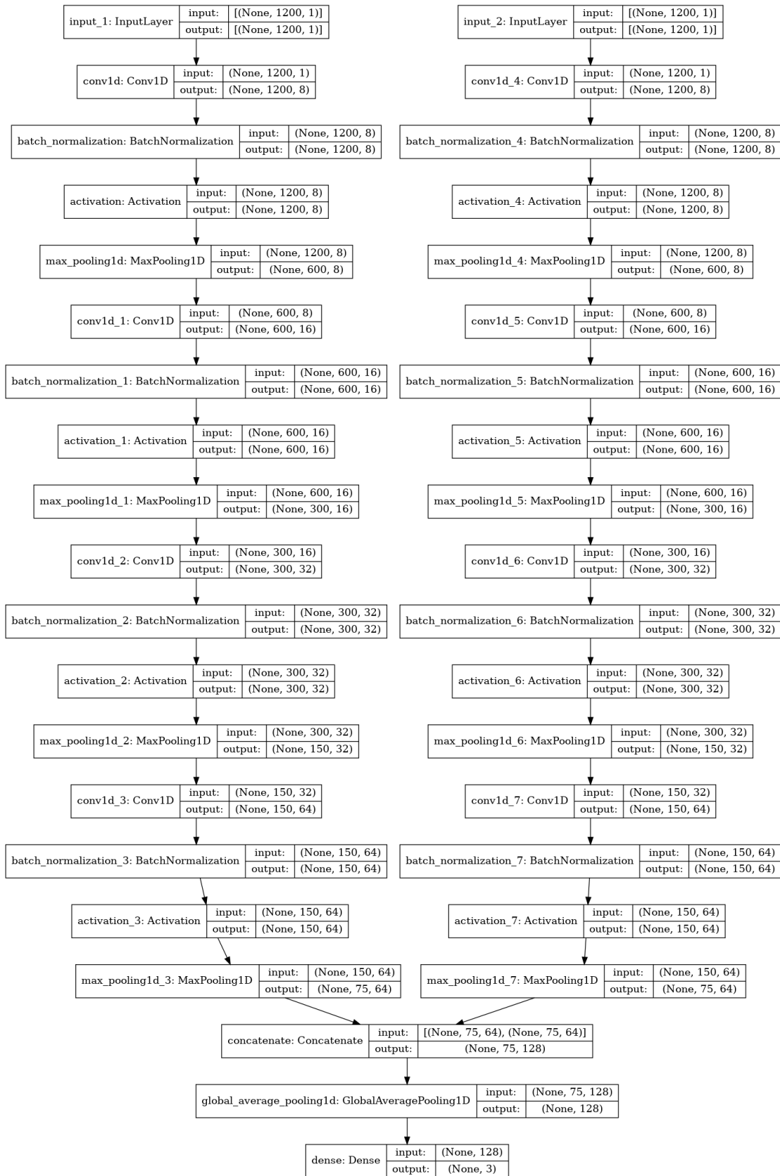
図 19 多入力深層学習モデルの構造
