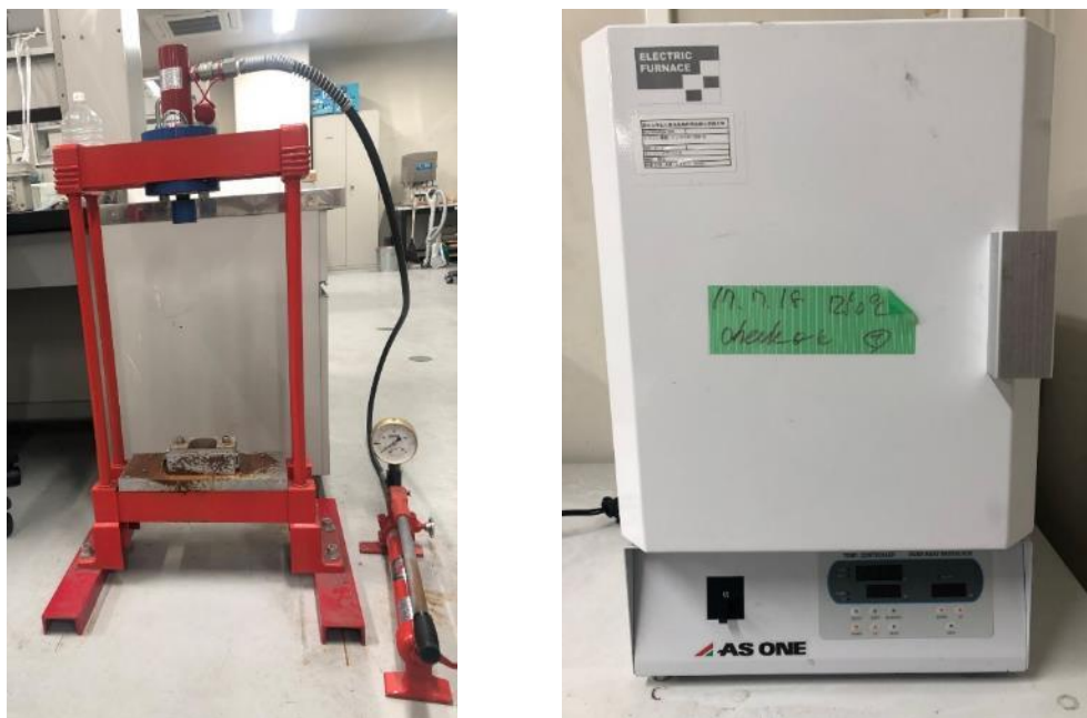
図 2.1.1 静水圧プレスユニットの外観 (左) [1]と MoSi ヒーター炉の外観 (右) [2]。
