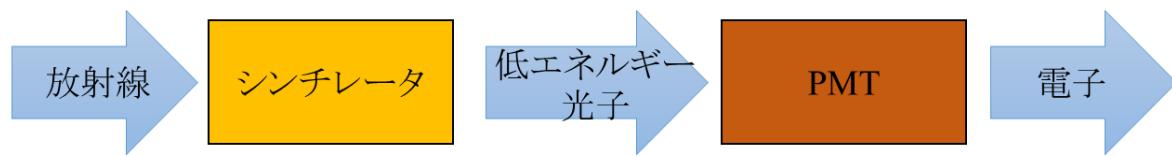
図 1.1 シンチレータを用いた放射線検出器の模式図。
