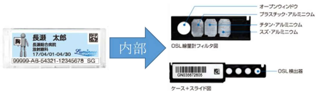
図 1.3 個人被ばく線量計の構造[20]。
