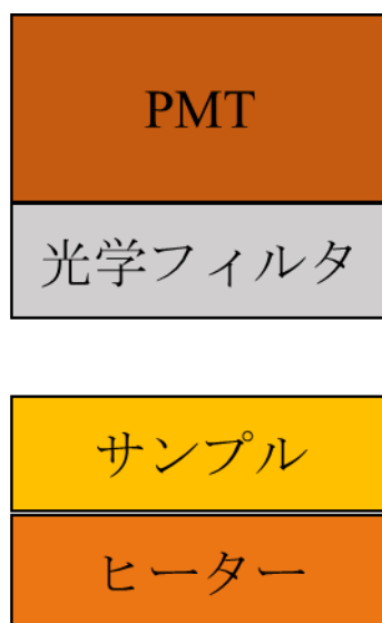
図 2.10 TSL グローカーブ測定装置の模式図。
