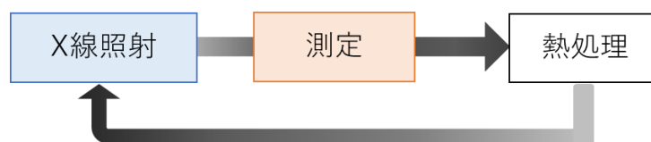
図 2.17 再使用性評価時の測定スキーム。
