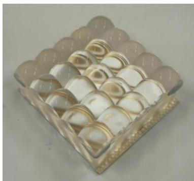
図4-1 薄型CPVモジュールの外観写真
