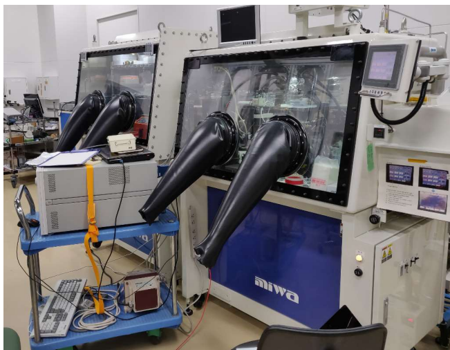
図 4.4 高純度窒素グローブボックス装置写真 (左) とグローブボックス内のフローバーシステム (右)
