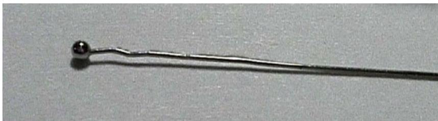
図 3.3 白金球電極の構造
