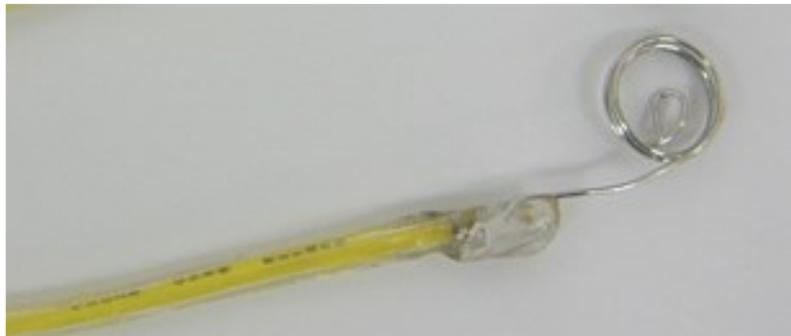
図 5.2 EIS 測定用の対向電極
