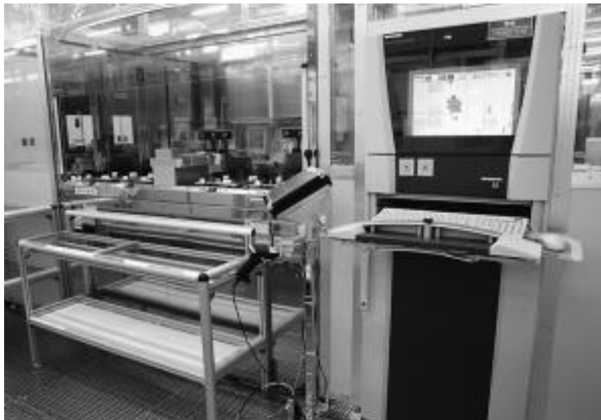
図 3-8 多層膜生成を実現するスパッタ装置
