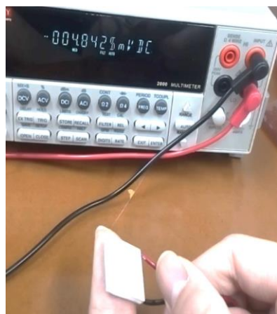
図 5.25 (a) 市販熱電素子の体温による発電 (b) 市販熱電素子の熱起電力
