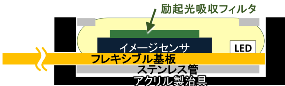
図 5.5 固定用治具を装着した金属外装 外径 2 mm センサのコンセプト
