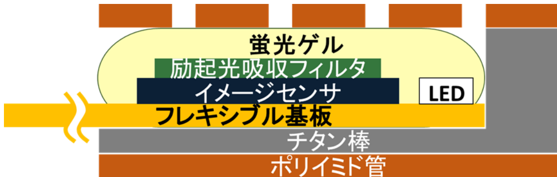
図 6.5 ポリイミド-金属外装 外径 1 mm センサの断面図
