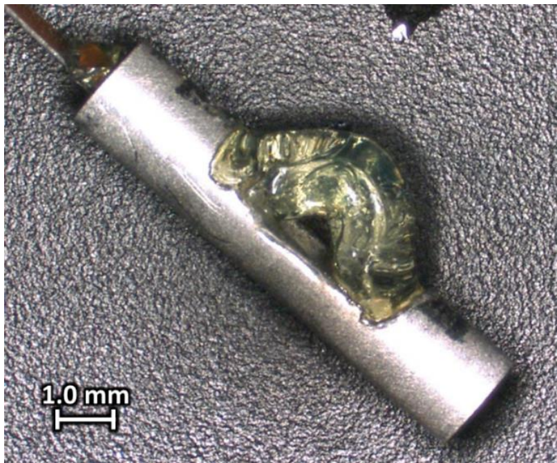
図 6.10 蛍光ゲルの膨潤による脱落の様子
