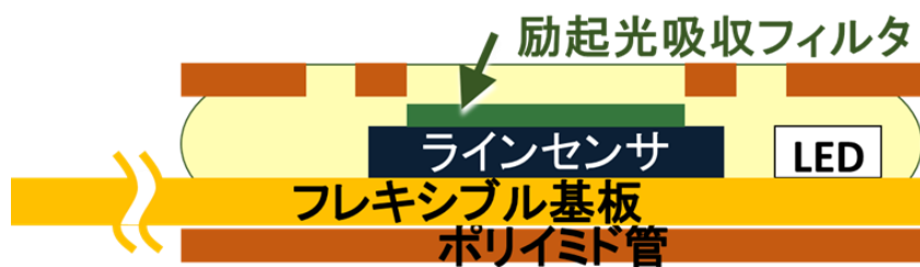
図 6.13 ポリイミド外装 外径 1 mm センサの断面図
