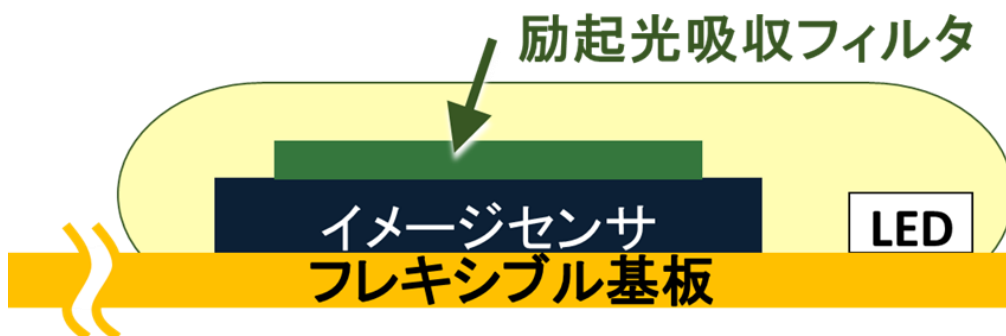
図 5.2 金属外装 外径 2 mm センサのコンセプト
