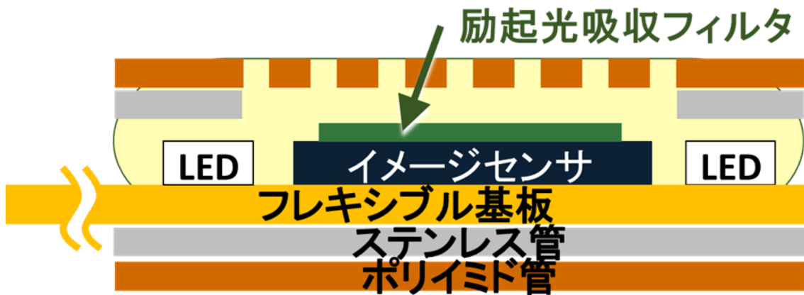
図 4.5 ポリイミド-金属外装 外径 3 mm センサの構造
