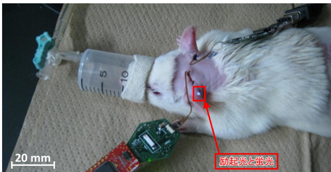
図 6.17 ポリイミド外装 外径 1 mm センサを用いた動物実験の様子
