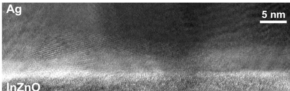
図 4.12. スパッタ成膜 Ag 電極と塗布型 InZnO 界面の断面 TEM 像.
