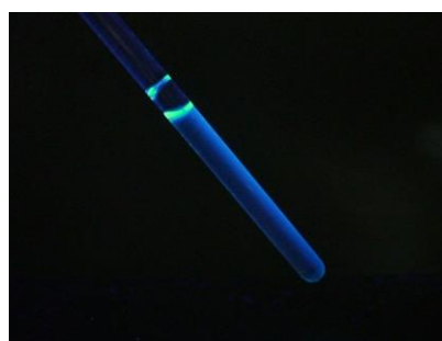
Figure 10. a) カルボン酸を例にした本保護基の推定脱保護機構；b) 蛍光スペクトル測定による脱保護過程の追跡；c) 化合物 2 の蛍光 ( \Phi=0.85 ) (参考文献 24a より引用)
