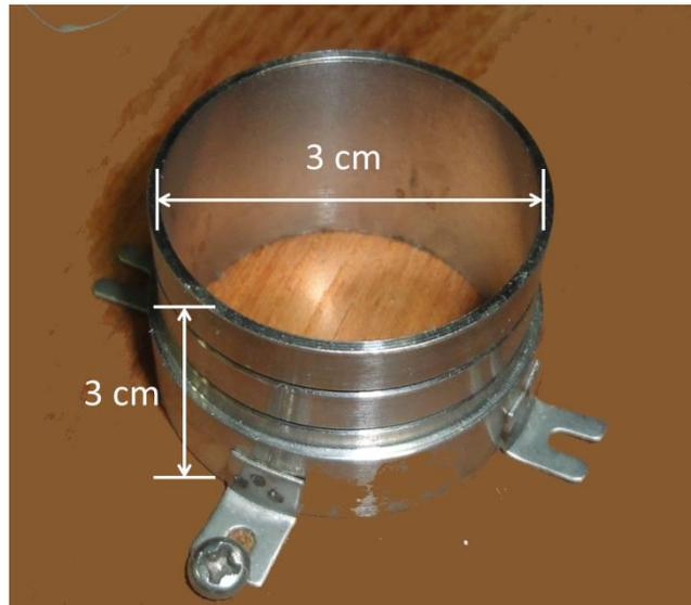
図 6.8 ニホンザルの頭部に設置するステンレス製チャンバー
