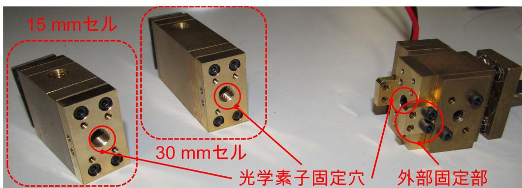
図 4.8: 改良型小型不斉計測デバイス.
