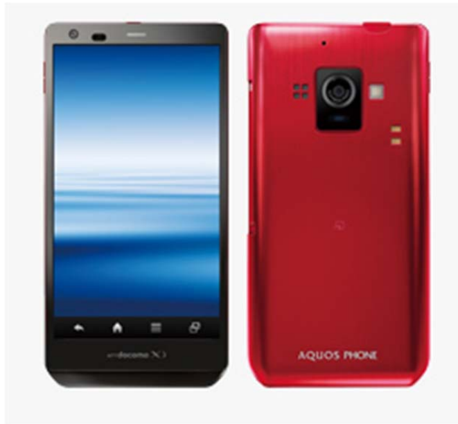
図 1-1 酸化亜鉛系 TFT 駆動有機 EL ディスプレイ搭載スマートフォン (Sharp, 2012) 7)
