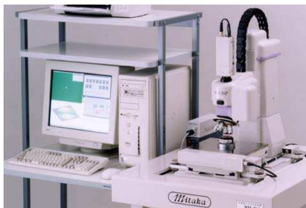
図 2.32 レーザー非接触 3 次元測定器の外観 [23] [24]
