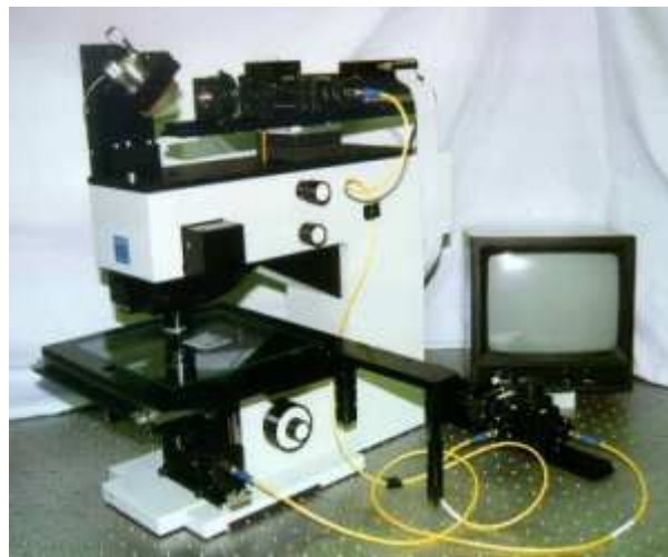
図 2.46 Mach-Zehnder 干渉計に光ファイバー光学系を採用した透過波面収差測定装置[31]
