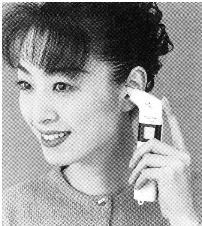
図 5-12 薄膜焦電型赤外線センサーを用いた非接触耳孔型体温計
