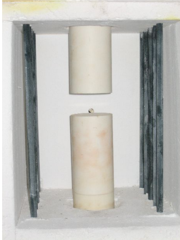
図 3.4 ホットプレス装置の炉内構造
