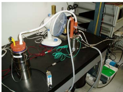
図 3.71 インピーダンスアナライザと連結した温度特性の測定系。液体窒素により冷却し、温調器により温度勾配を制御。
