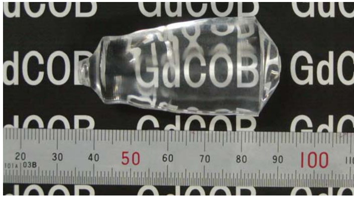
図 3.5 ポストアニールを施した GdCOB 結晶. 直径は 2.5~3.0 cm. 写真はカラー撮影.
