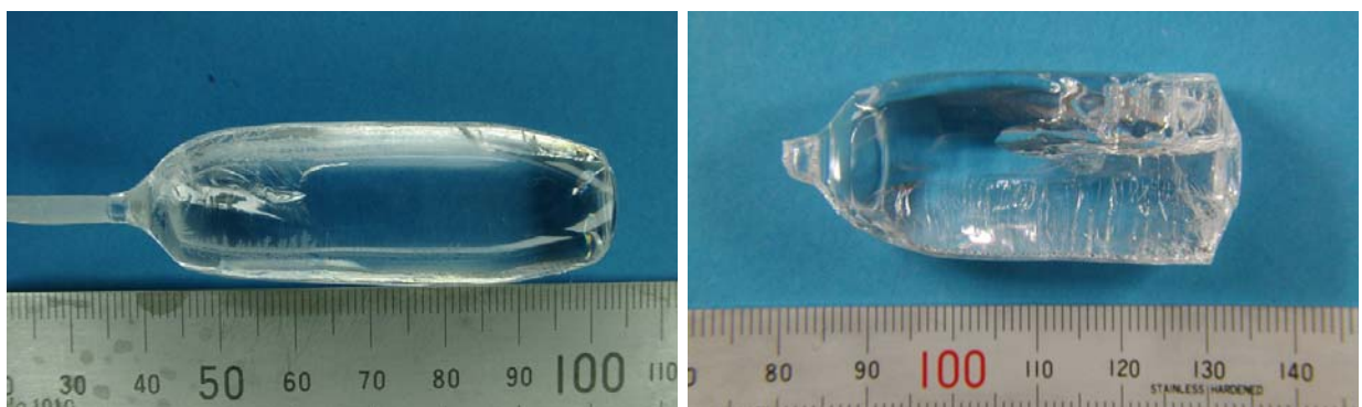
図 3.7 2.5 cm 程度の直径で作製したクラックの入った LaCOB As-grown 結晶. 写真はカラー撮影.
