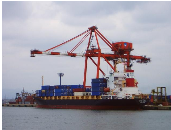
図 8 ガントリークレーンによる衛星遮蔽環境
