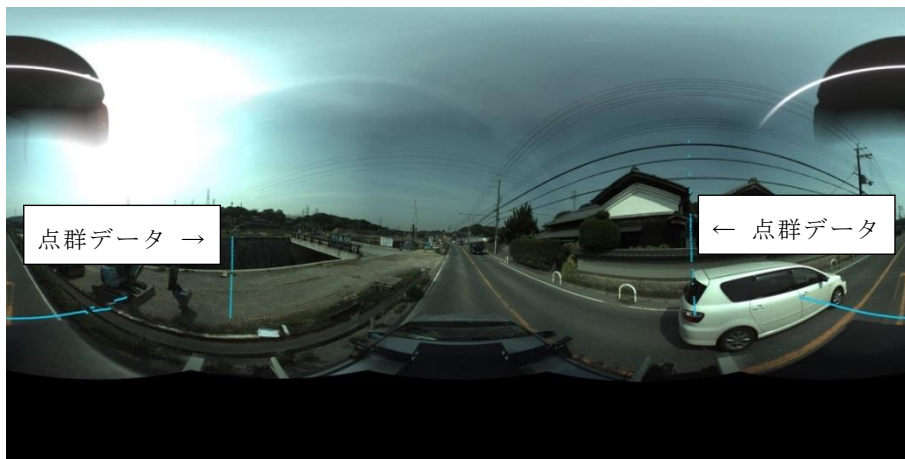
図 31 1 ライン分の点群データと全方位画像の合成 (画像番号 823)
