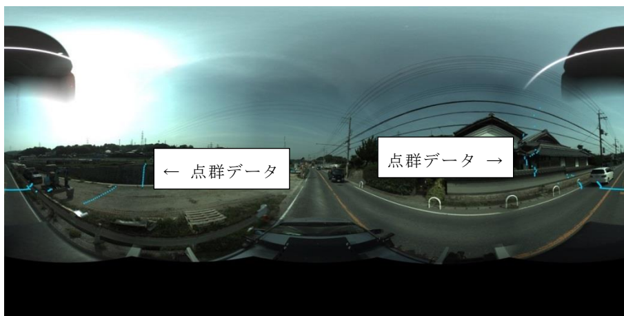
図 32 1 ライン分の点群データと全方位画像の合成 (画像番号 824)
