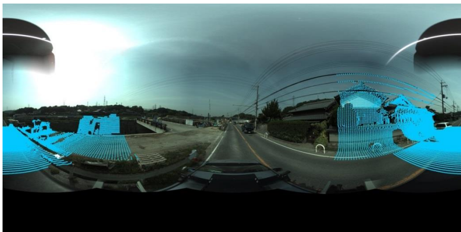
図 35 25000 点の点群データと全方位画像の合成 (画像番号 824)
