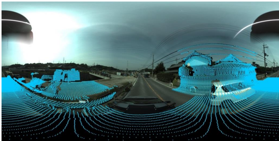
図 34 25000 点の点群データと全方位画像の合成 (画像番号 823)
