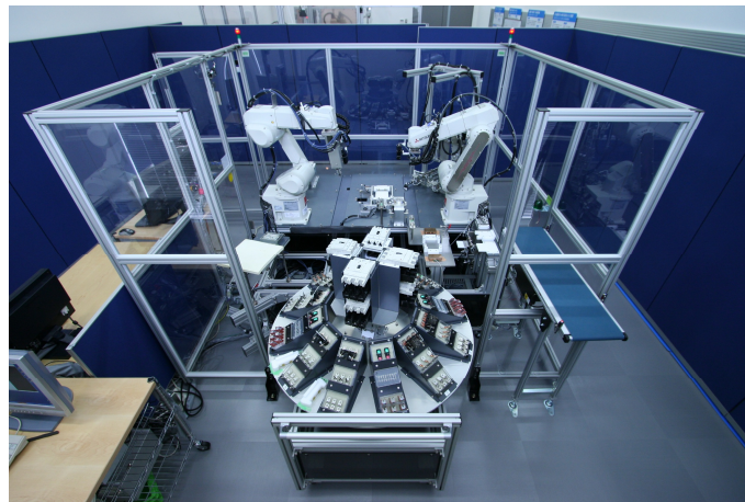
図 6.5 ブレーカ組立セル
