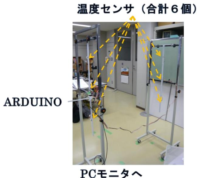
図3.6 2方向からの温度検出システム外観
