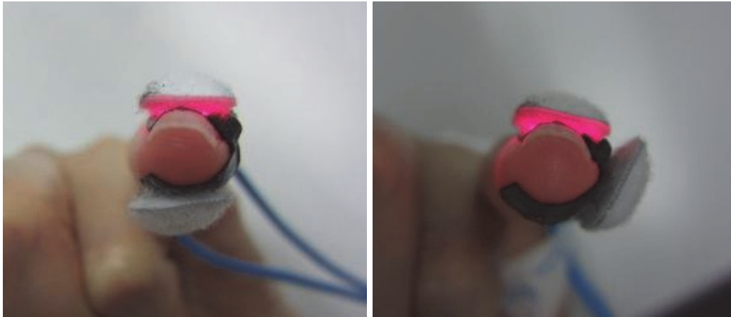
図 3.2 発光部, 受光部の装着位置. 左:180° 位置, 右:90° 位置.
