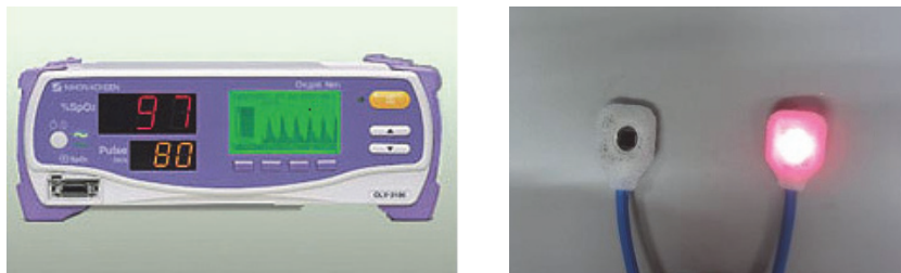
図 3.1 パルスオキシメータ OLV-3100 およびセンサ TL-260T. (いずれも日本光電製)
