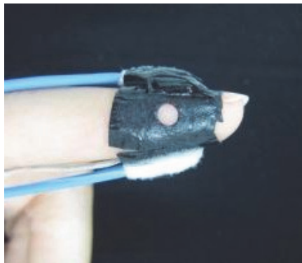
図 3.3 直径 3mm の穴を設けた黒色粘着テープ装着例.
