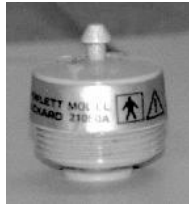
(a) ピエゾ接触型センサ (Hewlett Packard 21050A)
