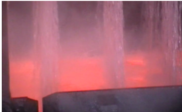
図 4 鋼板の水冷状況
