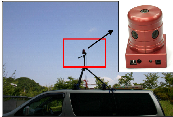
図 23 屋外環境で移動撮影するための車載全方位カメラ
