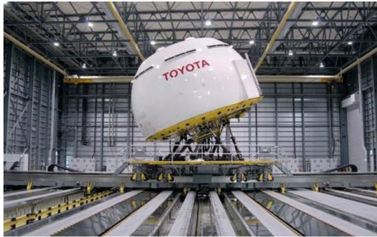
図 17 Wash Out を用いた高自由度ドライビングシミュレータの例 (トヨタ自動車)
