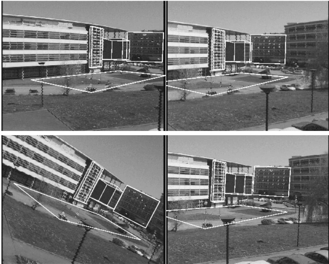
図 3 平面領域の追跡によるカメラ位置・姿勢推定 [SB02]
