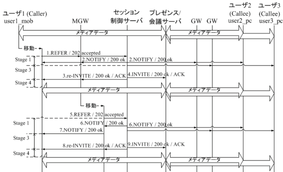
図 4.5 アクセスネットワークの切替えにともなうセッション切替えシーケンス例
