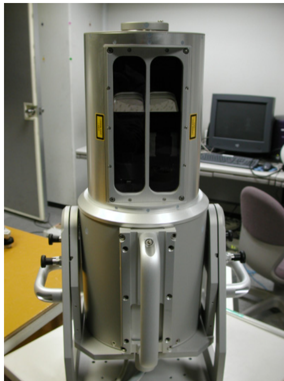
図4 全方位レンジファインダ LMS-Z360
