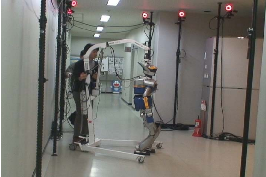
図 5.18 モーションキャプチャシステムによる歩行時の頭部位置，姿勢計測
