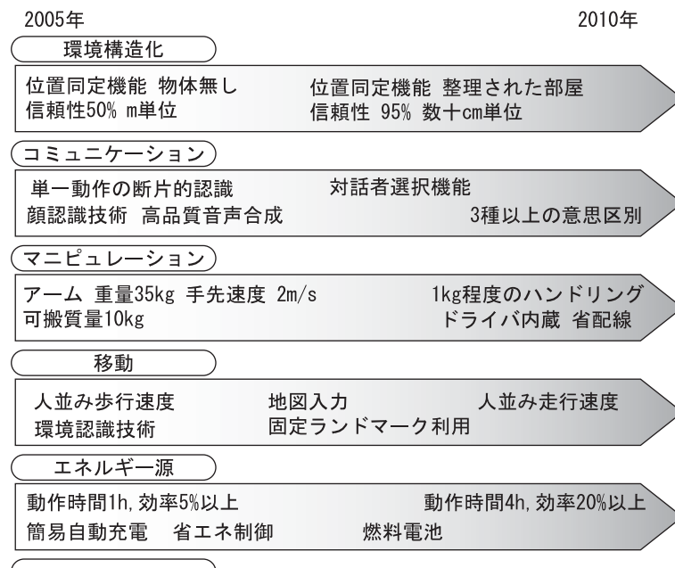
図 1.1 ロボット分野のロードマップにおける技術的課題（一部）
