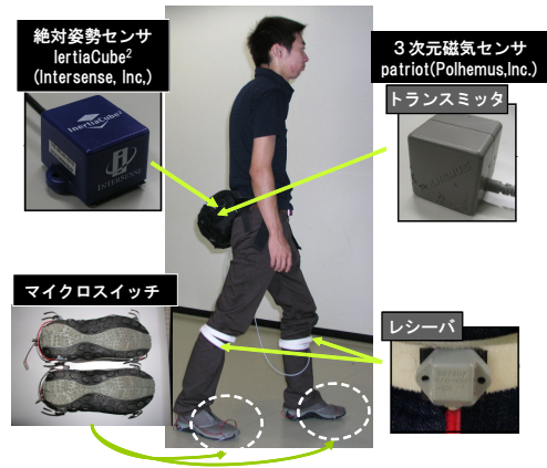
図 15 三次元磁気センサと姿勢センサを用いたユーザの自己位置推定 [YKY07]
