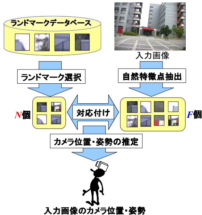
図 13 ランドマークデータベースを用いたカメラ位置・姿勢推定 [武富 08]
