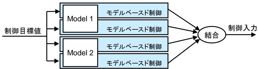
Fig. 13 二つの局所モデルに対して二つの制御器を構築して結合する制御系の構成
