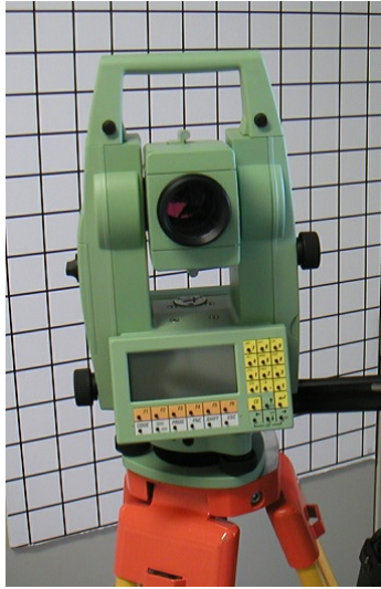
図 9 レーザレンジファインダの例 (左: Leica 社製 TCR1105XR, 右: Riegl 社製 LMS-Z360)
