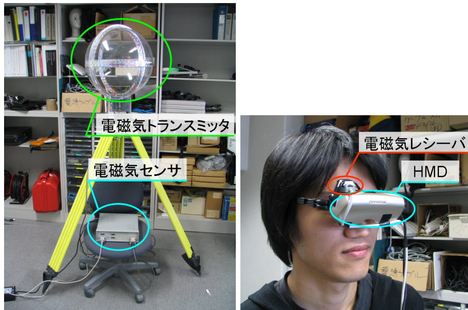
図 66 電磁気センサ（左）と電磁気レーザ付き HMD（右）
