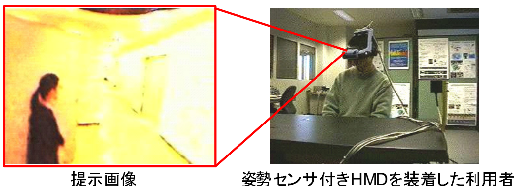
図 4 姿勢センサ付き HMD による視線追従型テレプレゼンスシステム [OYTY98]
