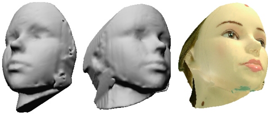
図 3.24 基礎実験②条件Ⅰのモデリング結果 プロジェクター : 2 台 (左右斜め方向から) シルエット処理画像 : 4,5,6,7,8,9,10, ステレオ処理画像 : (21,19,20),(22,24,23) テクスチャ処理画像 : 6,7,8
