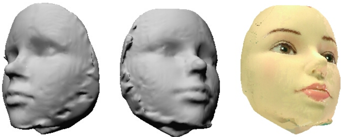
図 3.27 基礎実験②条件Ⅳのモデリング結果 プロジェクター : 1 台 (正面方向から) シルエット処理画像 : 2,3,5,7,8 ステレオ処理画像 : (18,16,17),(19,21,20) テクスチャ処理画像 : 2,5,8
