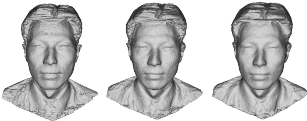
(1) 画像解像度：高 ボクセル解像度：中 (2) 画像解像度：低 ボクセル解像度：中 (3) 画像解像度：低 ボクセル解像度：低
