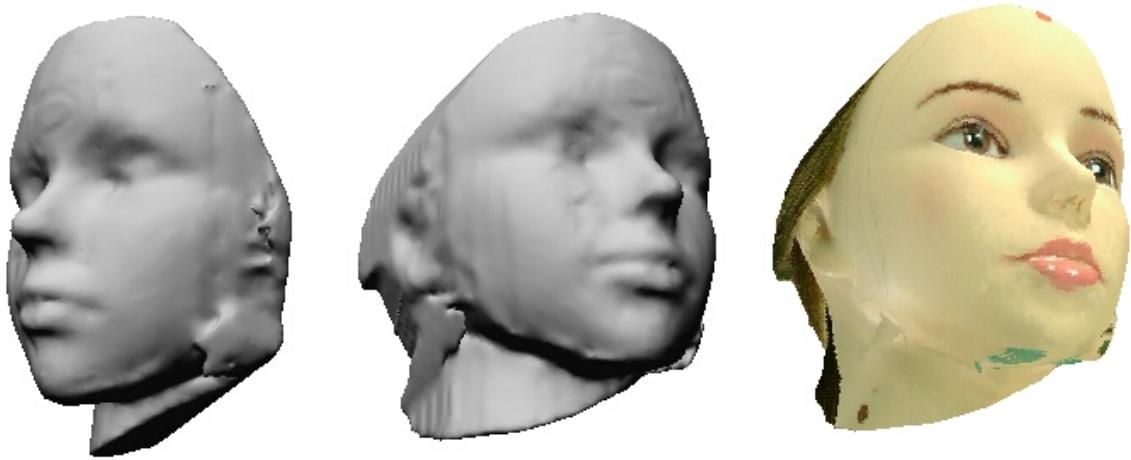
図 3.26 基礎実験②条件Ⅲのモデリング結果 プロジェクター : 2 台 (左右斜め方向から) シルエット処理画像 : 4,6,7,8,10 ステレオ処理画像 : (21,19),(22,24) テクスチャ処理画像 : 6,7,8
