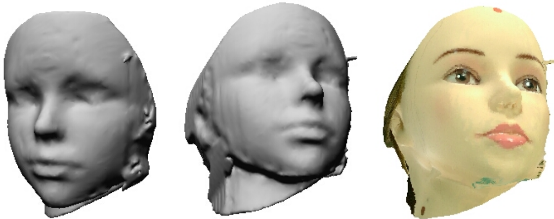
図 3.25 基礎実験②条件Ⅱのモデリング結果 プロジェクター : 2 台 (左右斜め方向から) シルエット処理画像 : 4,6,7,8,10 ステレオ処理画像 : (21,19,20),(22,24,23) テクスチャ処理画像 : 6,7,8
