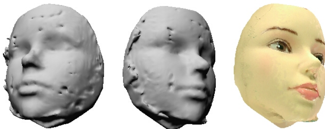
図 3.28 基礎実験②条件Vのモデリング結果 プロジェクター : 1台 (正面方向から) シルエット処理画像 : 2,3,5,7,8 ステレオ処理画像 : (18,16),(19,21) テクスチャ処理画像 : 2,5,8
