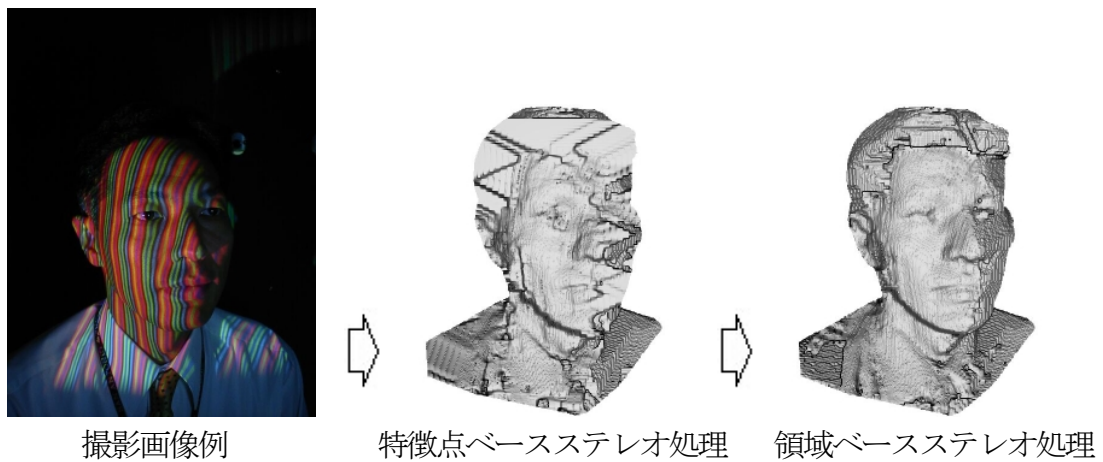
図 2.9 2段階ステレオ処理の流れ
