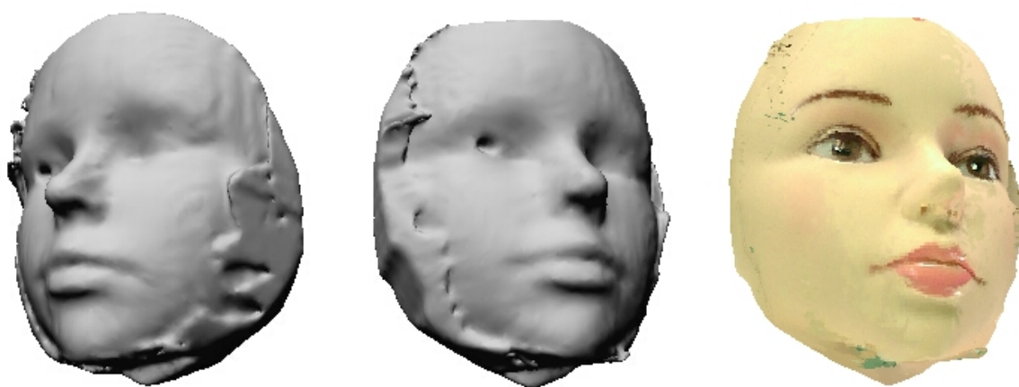
図 3.29 基礎実験②条件VIのモデリング結果 プロジェクター : 1台 (正面方向から) シルエット処理画像 : 2,3,5,7,8 ステレオ処理画像 : (18,19) テクスチャ処理画像 : 2,5,8
