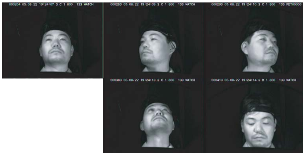
図 4.10 実環境中で計測された人物の頭部画像例．顔特徴点は頭部姿勢に応じてその「見え」を大きく変化させ，目尻など一部隠れてしまう特徴点も存在する．
