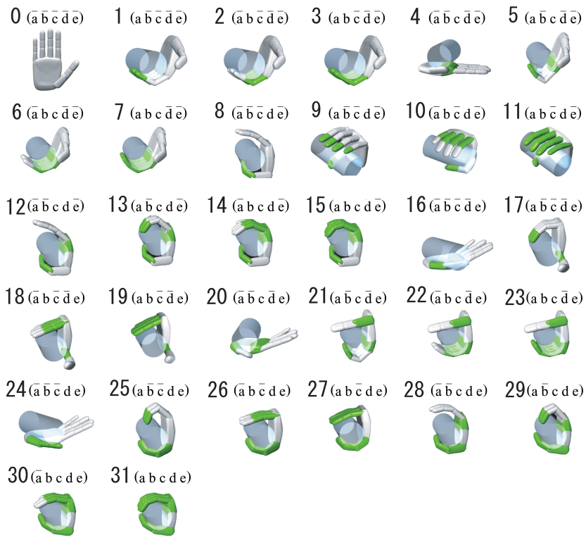
図 3.16 32 種類の接触状態
