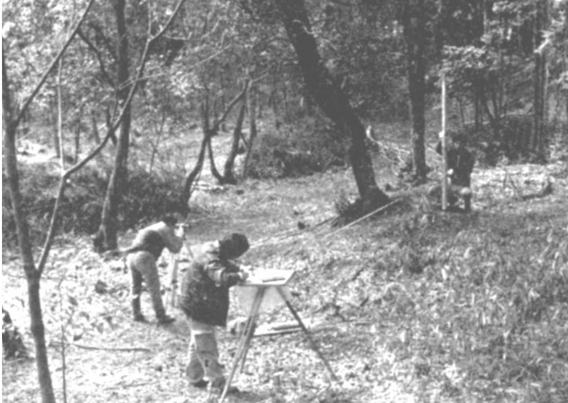
図 2.1 平板測量の様子 [27]
