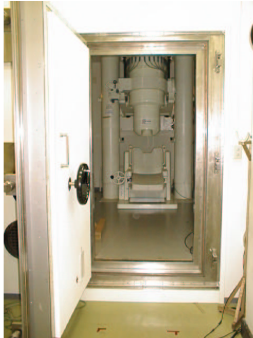
図 2.6 シールドルーム
