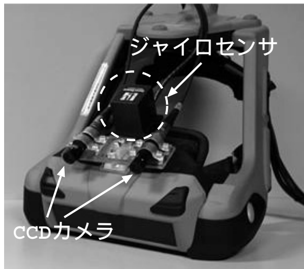
図 3.8 ジャイロセンサとステレオカメラを組合わせたビデオシースルー HMD
